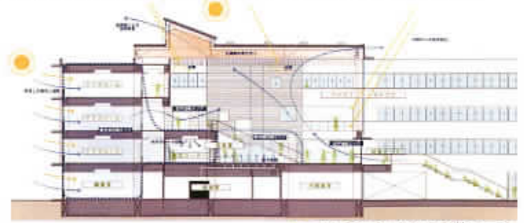
アカデミック・スクエア断面イメージ 自然採光や自然通風など自然エネルギーを活用するパッシブデザインを採用した学習環境
